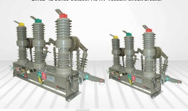
ZW32-12系列户外柱上交流高压真空断路器(以下简称断路器) 是最高额定电压为12kV,三相交流50Hz的户外配电设备。主要用于开断、关合电力系统中的负荷电流、过载电流及短路电流。 适用于变电站及工矿企业配电系统中作保护和控制之用,及农村电网频繁操作的场所。也可作为电网的分段开关,加装控制器后,可实现配网自动化。
