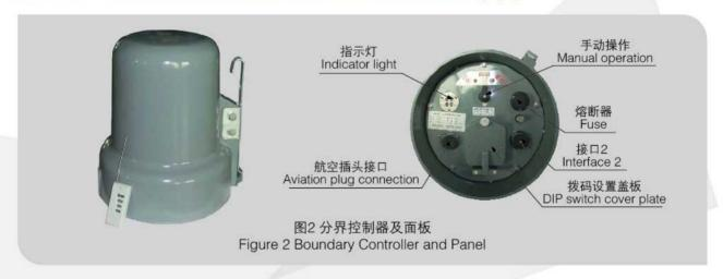
分界控制器在电力系统中实时监测配电系统的运行情况,能根据配电系统故障情况下的电参数数据变化实际,及时准确判断系统线路产生故障的性质(属于瞬时性/永久性),通过断路器自动切除永久性故障线路,恢复其它非故障线路的供电。本控制器具有防涌流、过流保护、速断保护、小电流接地保护和失压保护等保护环节,还具有重合闸功能、重合闸后加速功能。通过相应设定,可以实现配电线路的自动保护,非常适合在城乡配电网中使用。
